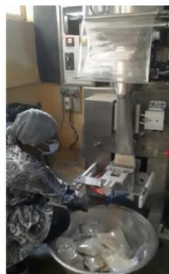
La conditionneuse dont le groupement Fara'a a bénéficié est un modèle de type SJIII-K300 qui permet d'emballer de produits sous forme de granules comme le dégué, le couscous, les brisures, brabousco, bassi, les grumeaux, etc.
