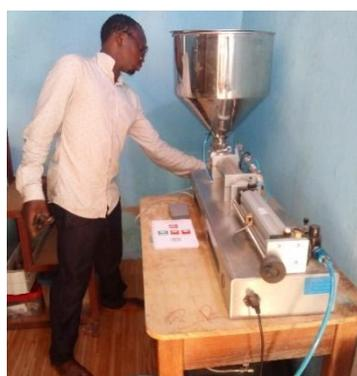
La conditionneuse subventionnée par HC3N est une doseuse de miel dans des bidons en plastiques. La conditionneuse permet de remplir les bidons pour un volume précis, compris entre 100 ml et 1 L. Elle a une capacité de production maximale de 40 bouteilles par minute, soit 240 bouteilles par heure ou 24 litres.
